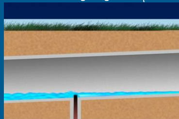
Abflusszustand: Entleerung Abflussregelung auf 2 Q_t
