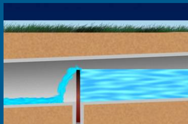
Abflusszustand: Volleinstau Abflussregelung auf 2 Q_t
