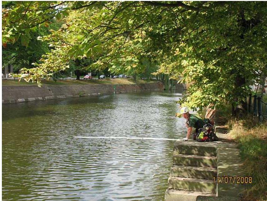
Abb.4: Abstandsmarkierung zur Bemessung des Lichtraumprofils für die Arbeitsplattform.
