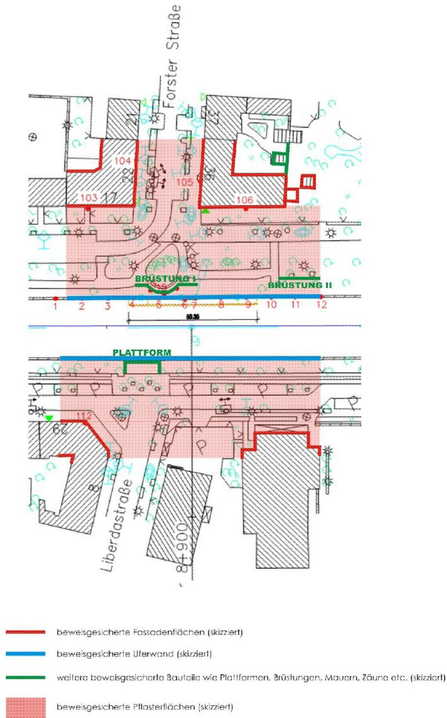
**Abbildung 3:** Lageplan mit den beweisgesicherten Bauteilen im Umfeld des Bauvorhabens *Teststrecke Crush Piler im Landwehrkanal*. In diesem Gutachten sind die Ergebnisse der gesamten bautechnischen Beweissicherung zusammengefasst. Die roten Zahlen 1 bis 15 und 103 bis 106 und 112 markieren die geodätischen Messpunkte (Prismen) der geodätischen Beweissicherung innerhalb des bautechnischen Beweissicherungsbereichs.
